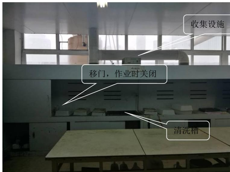
图 11 焊接清洗及废气收集设备
